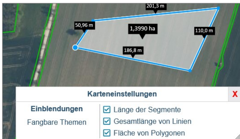
Abb. Anzeige der Segmentlängen und Flächengröße eines gemessenen Polygons
